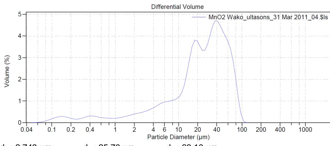
$d_{10}$ : 2.743  $\mu\text{m}$        $d_{50}$ : 25.70  $\mu\text{m}$        $d_{90}$ : 63.10  $\mu\text{m}$
