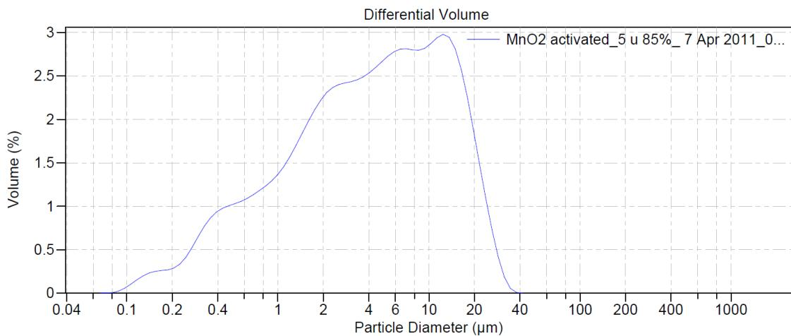
$d_{10}$ : 0.577  $\mu\text{m}$        $d_{50}$ : 4.240  $\mu\text{m}$        $d_{90}$ : 16.04  $\mu\text{m}$
