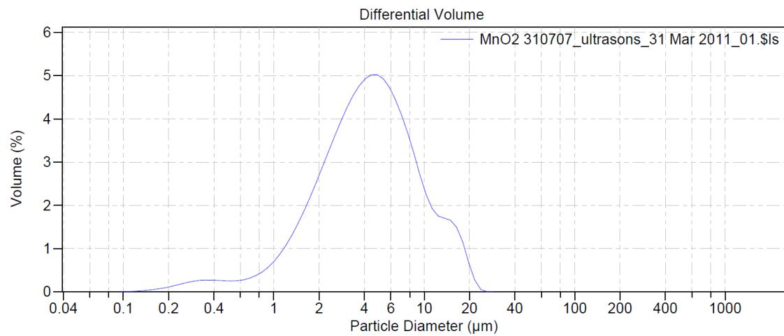
$d_{10}$ : 1.475  $\mu\text{m}$        $d_{50}$ : 4.302  $\mu\text{m}$        $d_{90}$ : 11.16  $\mu\text{m}$
