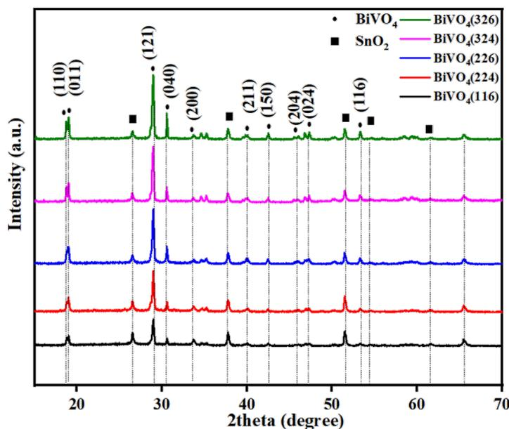
**Figure 1:** (a) XRD patterns of BiVO<sub>4</sub>(146), BiVO<sub>4</sub>(224), BiVO<sub>4</sub>(226), BiVO<sub>4</sub>(324), and BiVO<sub>4</sub>(326) photoanodes.
