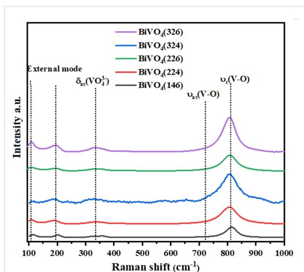
**Figure 4:** Raman spectrum of BiVO<sub>4</sub>(146), BiVO<sub>4</sub>(224), BiVO<sub>4</sub>(226), BiVO<sub>4</sub>(324), and BiVO<sub>4</sub>(326) photoanodes.
